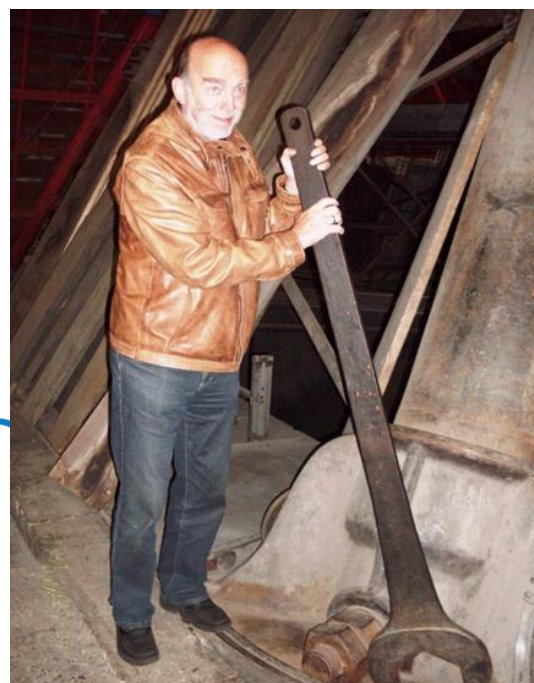
图5：科隆大教堂塔楼上螺栓的拧紧
